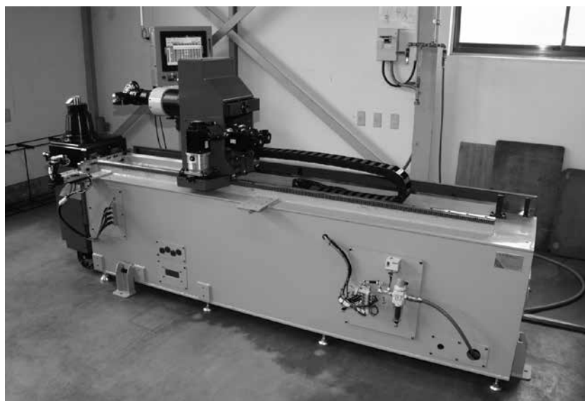
写真-5 最新の曲げ加工を実現する丸棒3Dベンダー機
