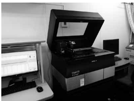
写真-11 まずは3Dプリンターで試作
