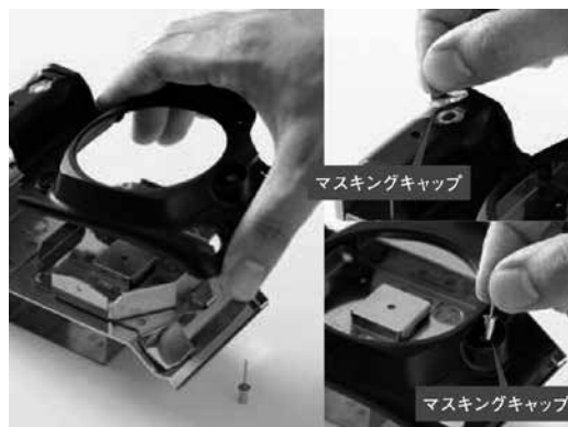
写真-4 マスキングキャップの設計・製作
