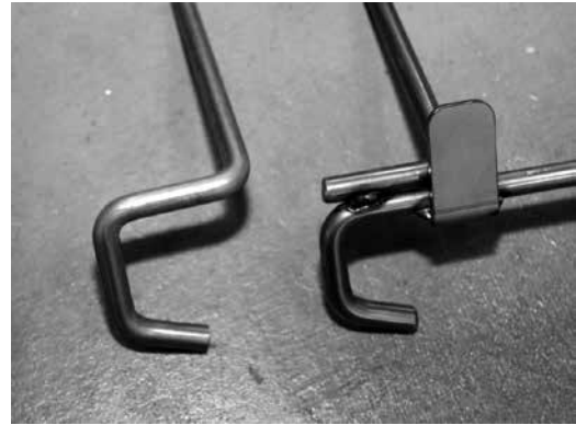
写真-7 左が最新の加工で右がこれまでの加工
